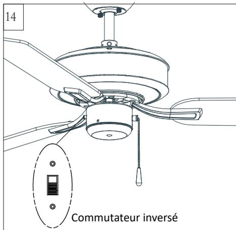
Le réglage du commutateur d'inversion en position basse se traduira par un flux d'air vers le bas et le réglage du commutateur en position haute se traduira par un flux d'air vers le haut.
