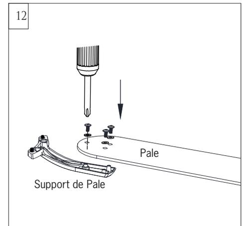
Monter la fixation de la pale à l'aide de 3 vis pour pale et rondelles en fibres fournies. Bien serrer. Répéter ce processus pour les pales restantes.
