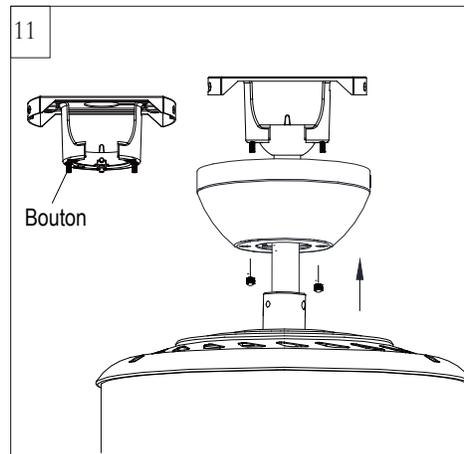
Soulevez l'auvent permettant aux 2 goujons de dépasser de l'auvent. Installez les écrous moletés (voir l'illustration). Serrez fermement les écrous moletés. L'auvent doit s'ajuster pour toute irrégularité au plafond ou dans la boîte de distribution.
